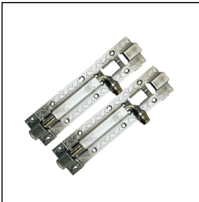
# 2008-6" SS กลอนสแตนเลส 430 (แพ็คคู่) ทำจากสแตนเลส 430 ปิดด้าน ขนาด 6" หนา 2 มม. แกนเหล็กเส้นผ่าศูนย์กลาง 9.5 มม.
