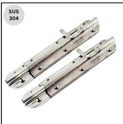
# 100-6" SS กลอนสแตนเลส ทำจากสแตนเลส 304 ปิดด้าน ขนาด 6" หนา 0.8 มม. แกน 7 มม.
