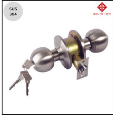
# 033 SS ลูกบิดประตูทรงกลมฝาใหญ่ ถ้วยจับ SUS 304 กุญแจระบบ 5 ลูกป็นกลม ตัวเรือนกว้าง 28 มม. - 45 มม. ใส่กุญแจและดอกกุญแจทองเหลือง
